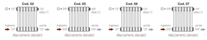
Per batterie Tesi con altezza superiore a 1000 mm o per batterie con meno di 15 elementi inserire diaframma sul lato ingresso acqua. Vedi allacciamenti riportati sotto cod. 08, 09, 10, 11.
